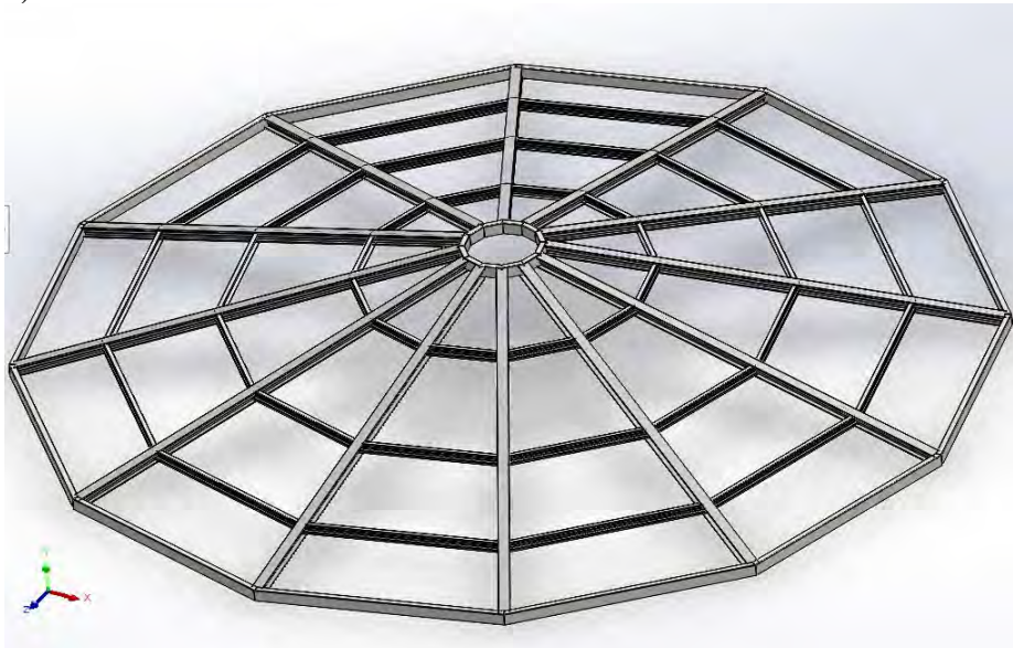
а) – твердотельная параметрическая модель купола, б) – эскиз поперечного сечения профиля несущего ребра Рисунок 1 – Исследуемая конструкция – купол
