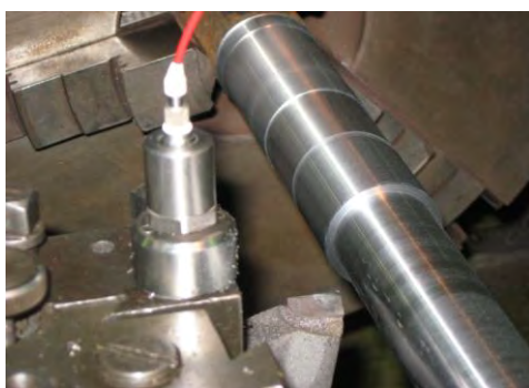
Рисунок 1 – Схема установки акселерометра при проведении эксперимента
