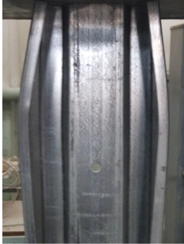
Рисунок 5 – Испытания короткого (а) и длинного (б) образцов
