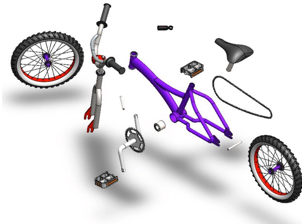
Рисунок 1 – Компоненты параметрической модели «Велосипед»
