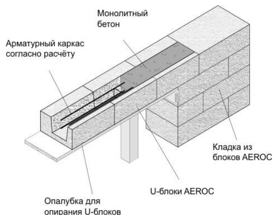
Рисунок 4 – Устройство перемычки
