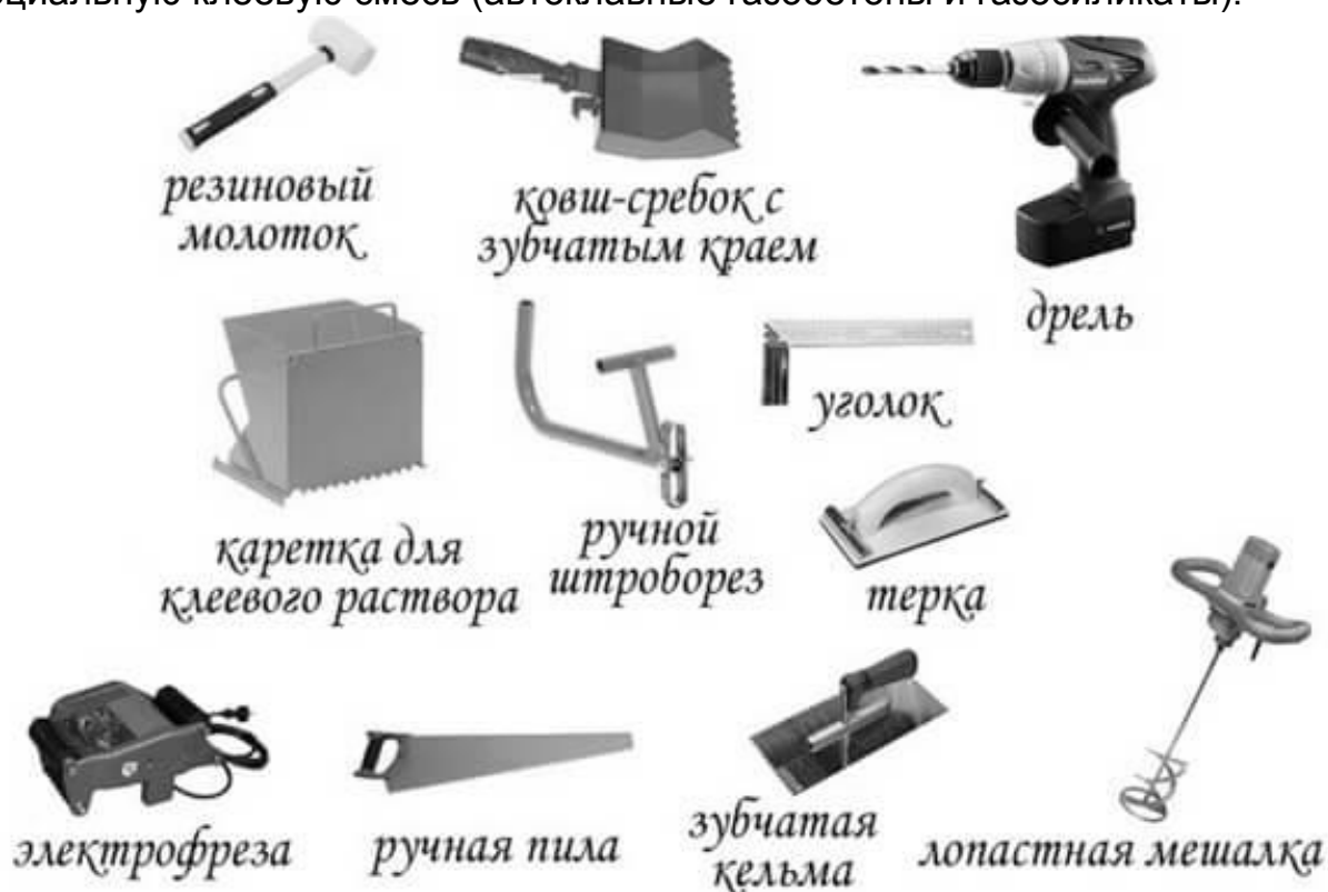
Рисунок 2 – Инструмент для кладки блоков на клеевой раствор
