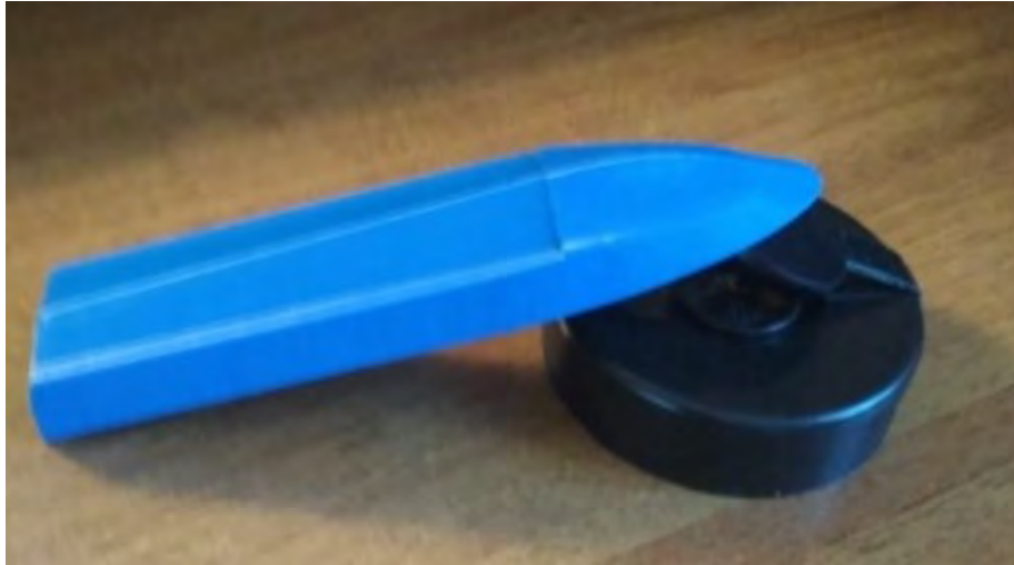
Рисунок 6 – Твёрдотельная модель (оболочка) корпуса катера
