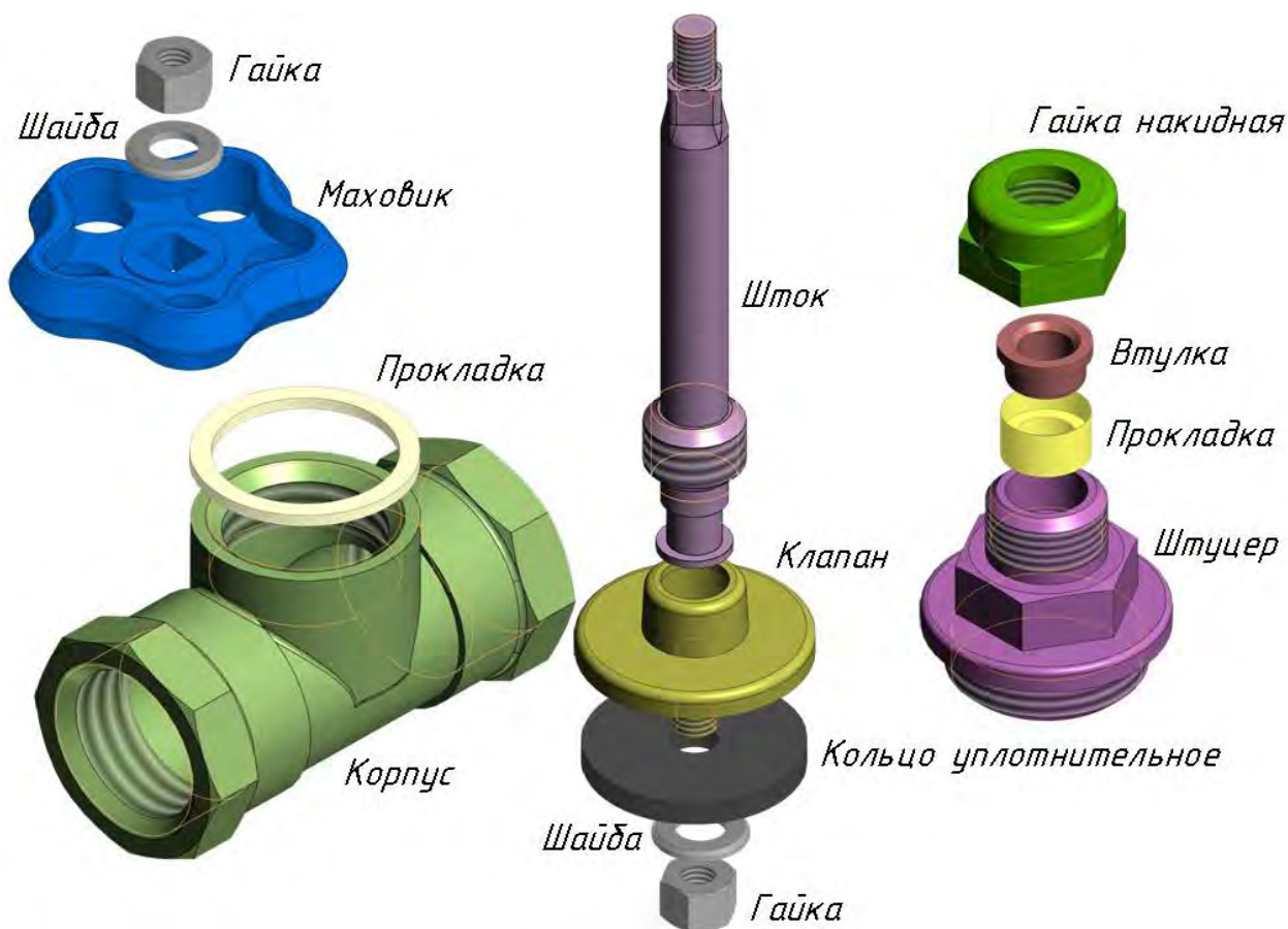
Рисунок 2 – Детали, входящие в сборочную единицу «Вентиль»
