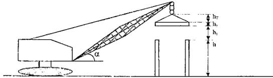
Рисунок 7.1 – Схема монтажа конструкции краном
