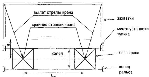
Рисунок 7.2 – Обозначение и привязка к зданию подкрановых путей
