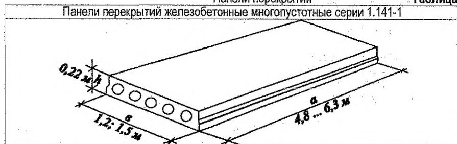
В выпуске 1-5 серии 1.141-1 включены предварительно напряженные панели с круглыми пустотами шириной 1490 и 1190 мм, длиной соответственно 6280, 5980, 5380, 5080 и 4780 мм. В выпуске 6 включены аналогичные панели тех же длин шириной 990 мм.
