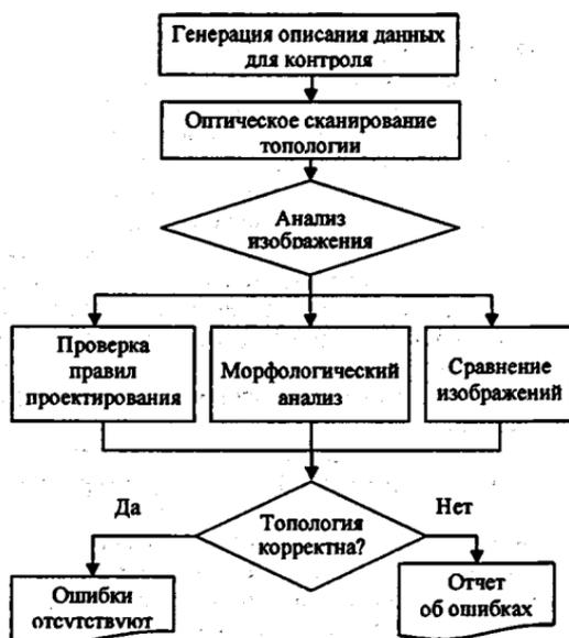
Рисунок 6.3.1 – Схема комбинирования методов оптического контроля
