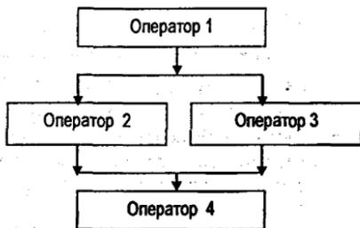
Рисунок 1.2.3 – Фрагмент параллельной ГСА
