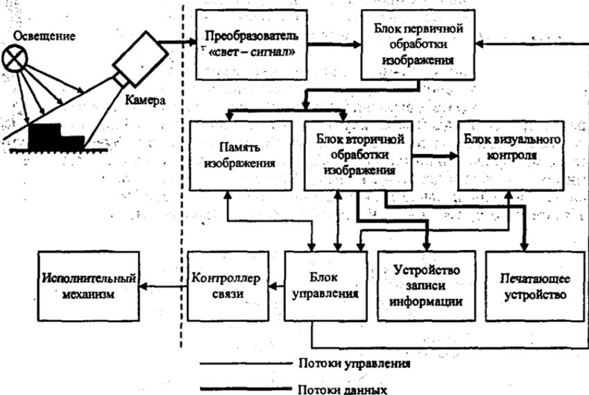
Рисунок 6.3.2 – Функциональная схема СТЗ контроля
