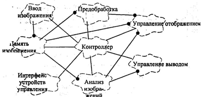
Рисунок 6.3.3 – Архитектура ПО СТЗ
