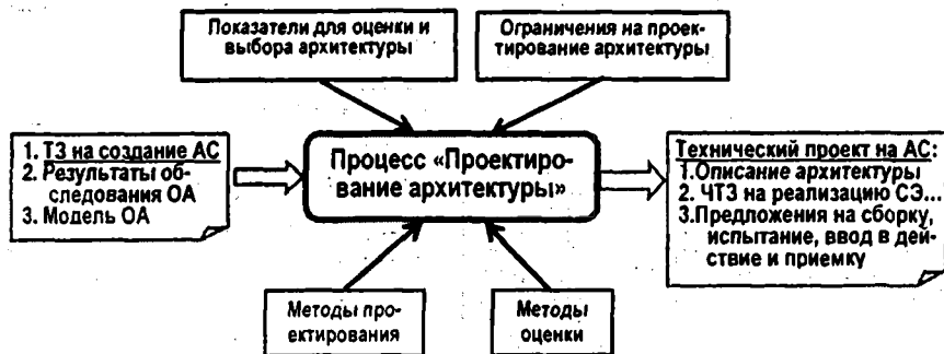
Рисунок 2.11 – Структура процесса «Проектирование архитектуры»
