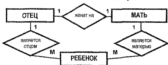
Рис.3.8. Пример множественных связей, не являющихся избыточными
