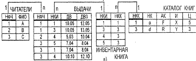
Рис. 7. Библиотека. Реляционные модели, нормальные формы: а) первая (таблица Книговывадачи - аналог формуляра читателя); б) вторая; в) третья
