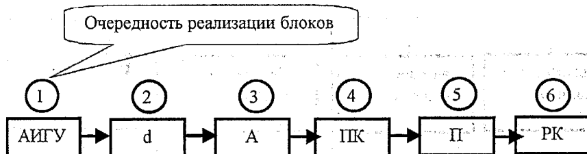
Рис. 3.1. Схема проектирования фундаментов
