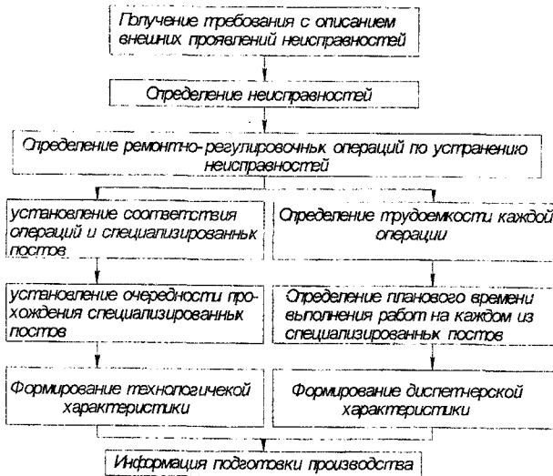
Рисунок 3.1 – Структурная схема алгоритма формирования диспетчерской и технологической характеристик требования
