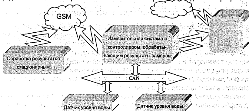
Рисунок 1 – Применение системы для мониторинга паводка
