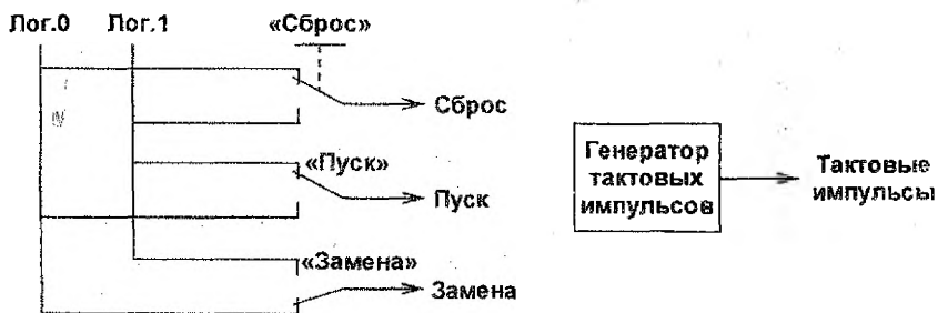
Рисунок 3.7 – Структура формирователя управляющих сигналов (положение органов управления показано в режиме тестирования)
