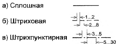
Рисунок 2.6 – Начертания линий в электрических схемах
