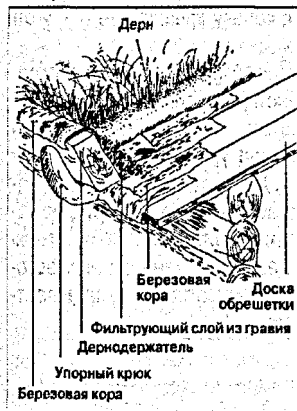
Рисунок 3 – Устройство крыши
