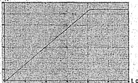
Рисунок 2 – Реакция системы на линейно возрастающее входное воздействие
