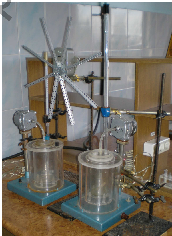
Рис. 1. Автоматическая установка типа «коррозионное колесо» для коррозионных испытаний при переменном погружении образцов в электролит
