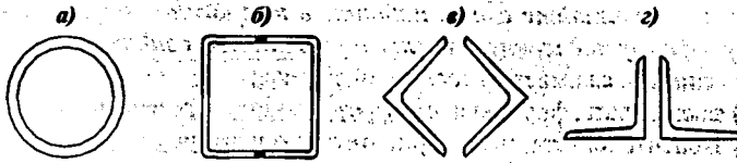
Рисунок 9. Типы сечений раскосов связевых ферм:
