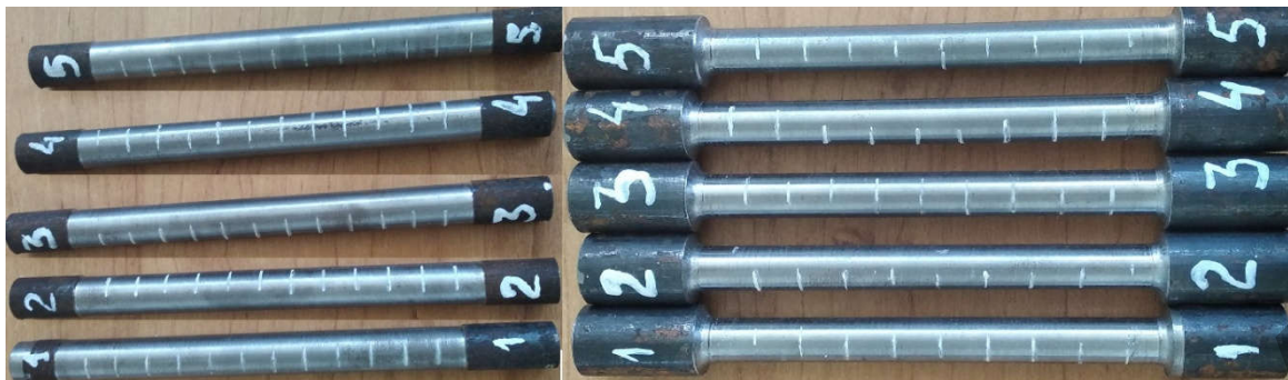
Рисунок 1 – Образцы для испытаний диаметром 13 мм и 10 мм
