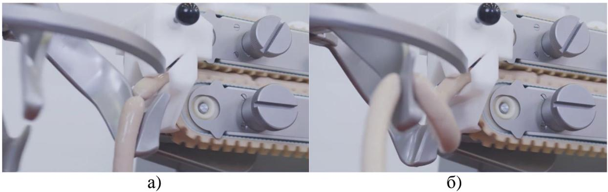
**Рисунок 2 – Принцип работы навешивающего устройства Handtmann PVLH 228 plus**
