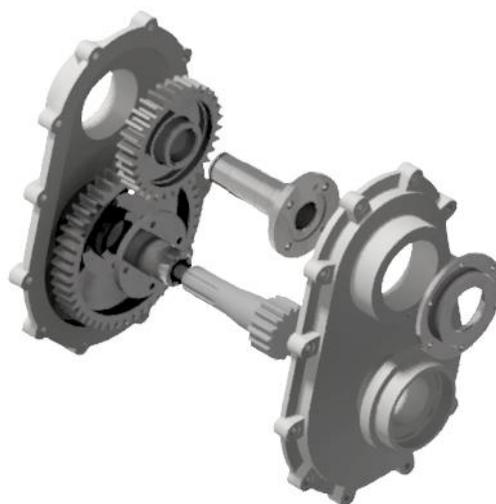
*Рисунок 1 – Разнесенная схема сборки редуктора привода лебедки*
