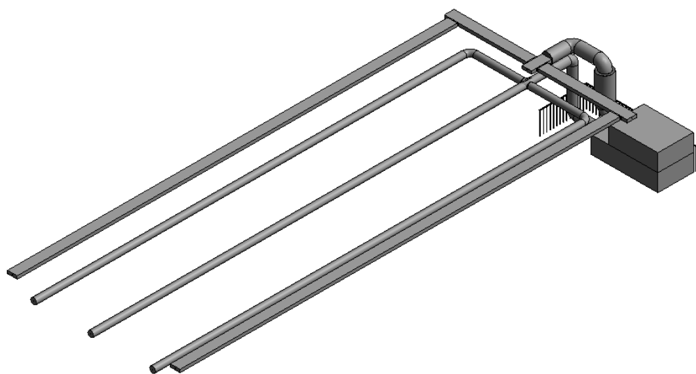
Рисунок 3 – Конфигурация системы кондиционирования с текстильными воздуховодами
