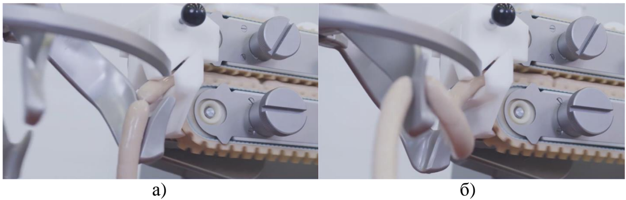
Рисунок 2 – Принцип работы навешивающего устройства Handtmann PVLH 228 plus
