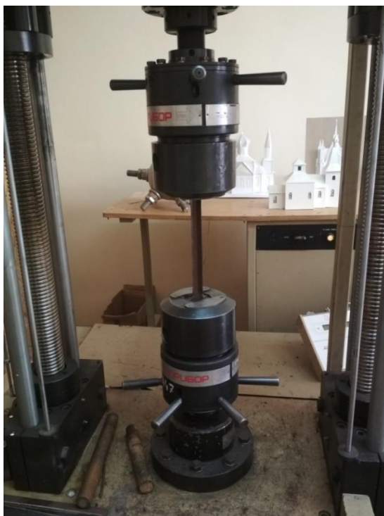
Рисунок 3 – Испытания на растяжение на машине ИР 5145-500
