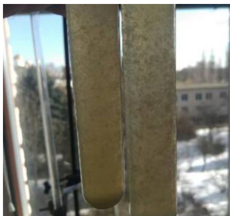
Рисунок 1 – Процесс хлопьеобразования, в обрабатываемой сточной воде при добавлении коагулянта
