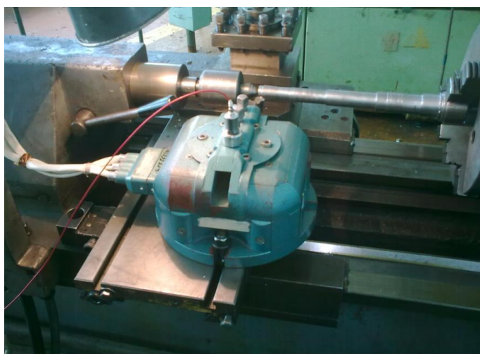
Рисунок 1 – Установка динамометра СУРП-600 и пьезоэлектрического акселерометра на станке «Куссон»
