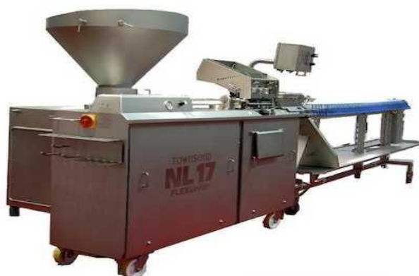
а – Vemag LPG218 и AH219; б – Handtmann PVLH 228; в – Townsend Рисунок 4 – Комплексы оборудования для формования сосисок
