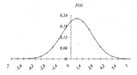
Построим схематический график этой функции. При x=a=0.7 функция достигает максимального значения  $f(0,7)=f_{\max}=\frac{1}{1.8\sqrt{2\pi}}\approx 0.22163$ . При  $x=a\pm\sigma$  график функции имеет перегиб (в данном случае в точках x=-1.1 и x=2.5,  $f(-1.1)=f(2.5)=\frac{1}{1.8\sqrt{2\pi}}e^{\frac{1}{2}}\approx 0.1344$ ).
