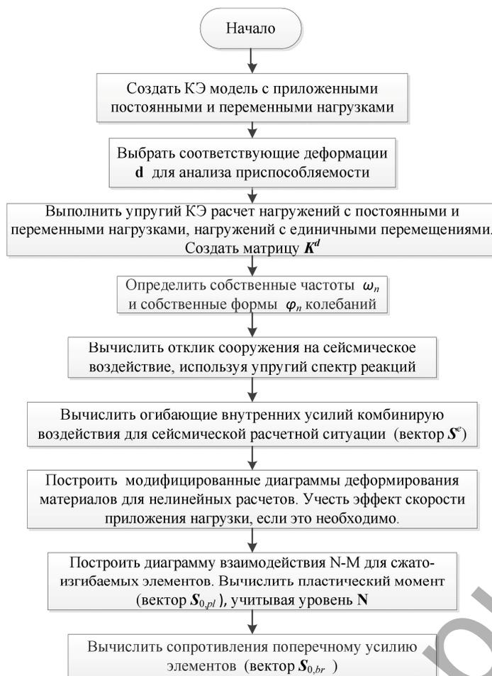
Рисунок 13 – Общая блок-схема расчета приспособляемости при сейсмическом воздействии (начало)
