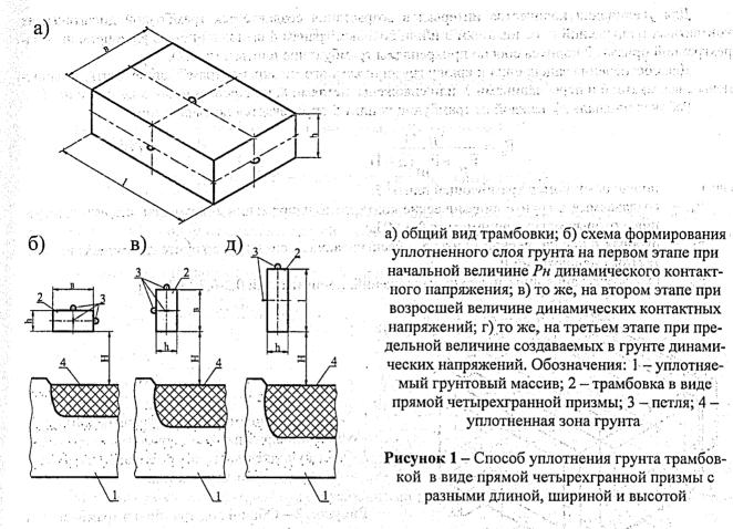
а) общий вид трамбовки; б) схема формирования уплотненного слоя грунта на первом этапе при начальной величине Рн динамического контактного напряжения; в) то же, на втором этапе при возросшей величине динамических контактных напряжений; г) то же, на третьем этапе при предельной величине создаваемых в грунте динамических напряжений. Обозначения: 1 - уплотняемый грунтовый массив; 2 – трамбовка в виде прямой четырехгранной призмы; 3 – петля; 4 – уплотненная зона грунта
