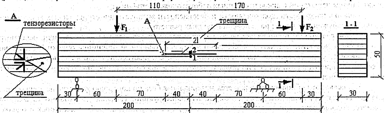
Рисунок 1— Схема балочного образца с трещиной, расположенной по нейтральной оси
