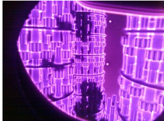
Рисунок 2 – Варианты тлеющего разряда при ионном азотировании: аномальный (а) и нормальный на части садки при повышении давления в камере при постоянной мощности (б)
