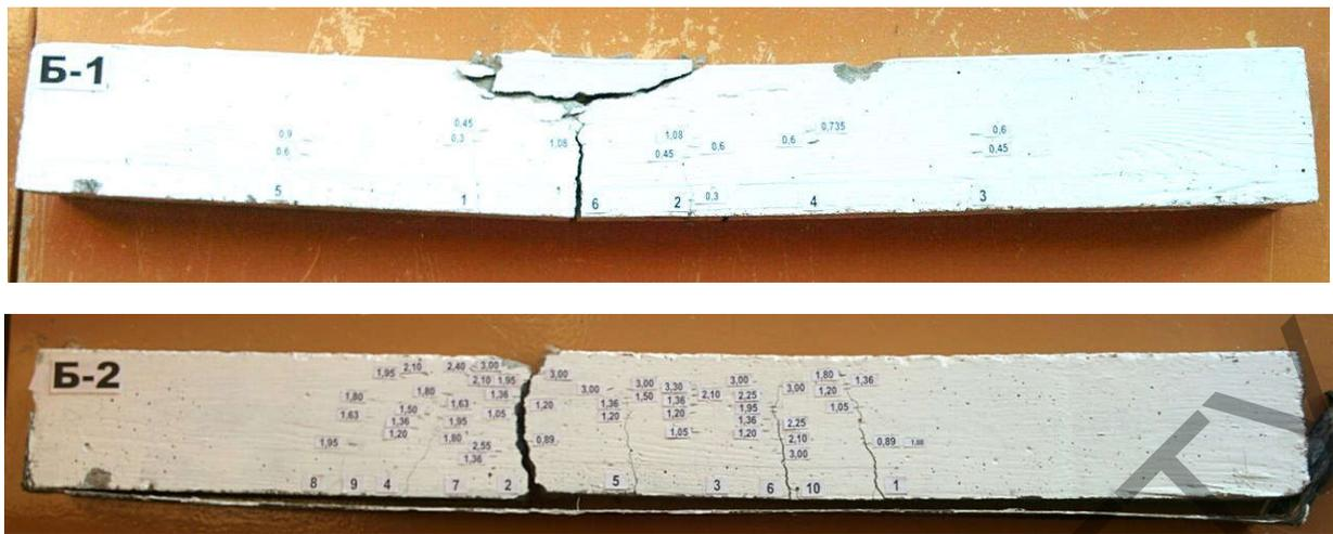
Рисунок 2 – Характер разрушения экспериментальных балок
