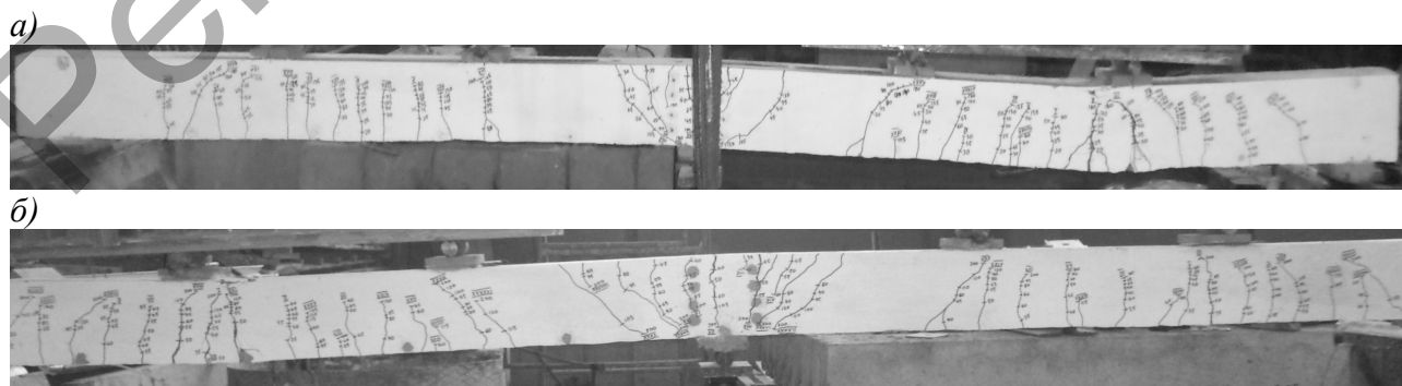
Рисунок 5 – Балка Б3(а) и Б1Э(б) после испытания
