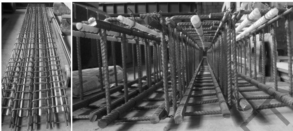
Рисунок 2 – Вязанные каркасы образцов-балок
