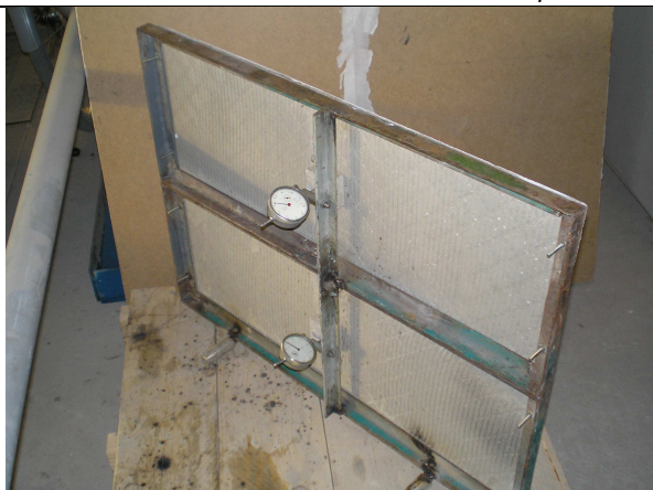
б) а – общий вид образцов ЦСП; б – схема размещения индикаторов ИЧ-10 Рис. 5. Конструкция опытной установки
