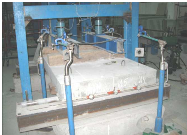
Рис. 6. Общий вид испытания плит на изгиб
