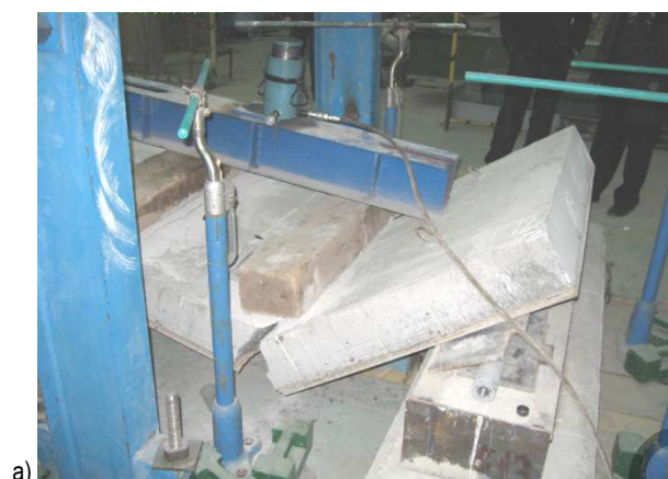
Рис. 9. Средние деформации в ЦСП на участке между трещинами в зоне чистого изгиба
