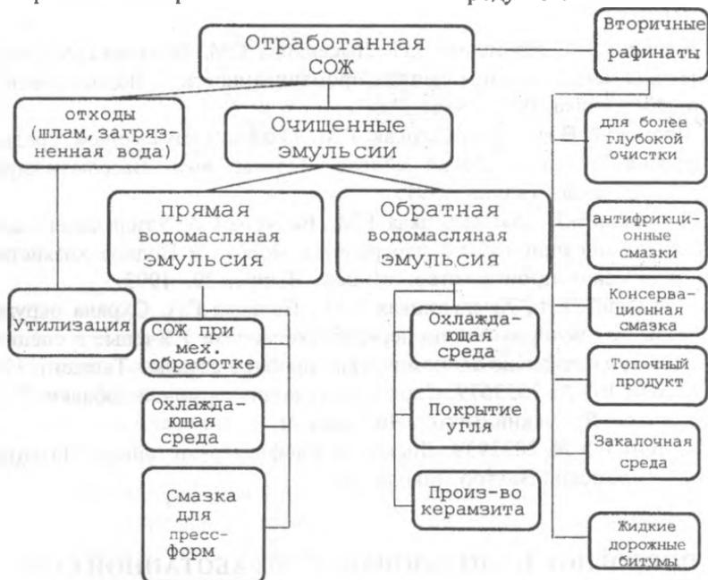
Рисунок Области применения продуктов разрушения отработанной СОЖ.
