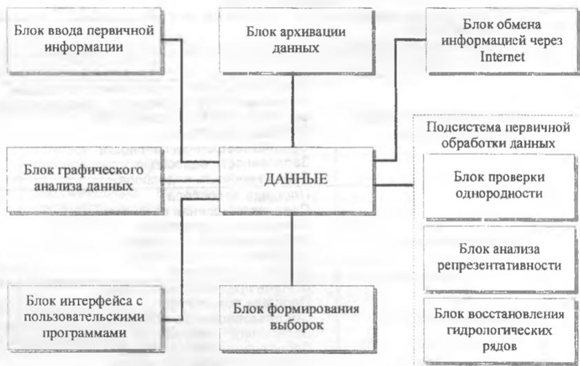
Рисунок 1 Структурная схема Системы Управления Базами Данных.
