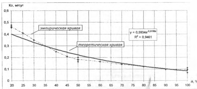
Рисунок 3 – График зависимости k_c = f(A_2) , A = 20,100 в рабочем диапазоне, обеспечивающем отведение фильтрационных вод с интенсивностью на уровне окружающего дренируемого грунта ( k_c < 0,5 м/сут)
