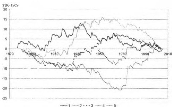
Рисунок 2 – Разностные интегральные кривые максимальных расходов воды дождевых паводков рек 1 – Зап. Двина (г. Витебск), 2 – Неман (г. Гродно), 3 – Березина (г. Борисов), 4 – Копаювка (с. Черск), 5 – Припять (г. Мозырь)
