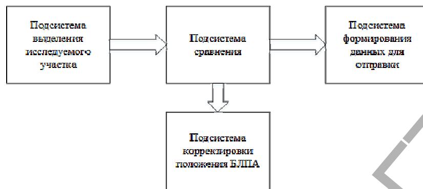
Рисунок 1 – Структурная схема программной части модуля
