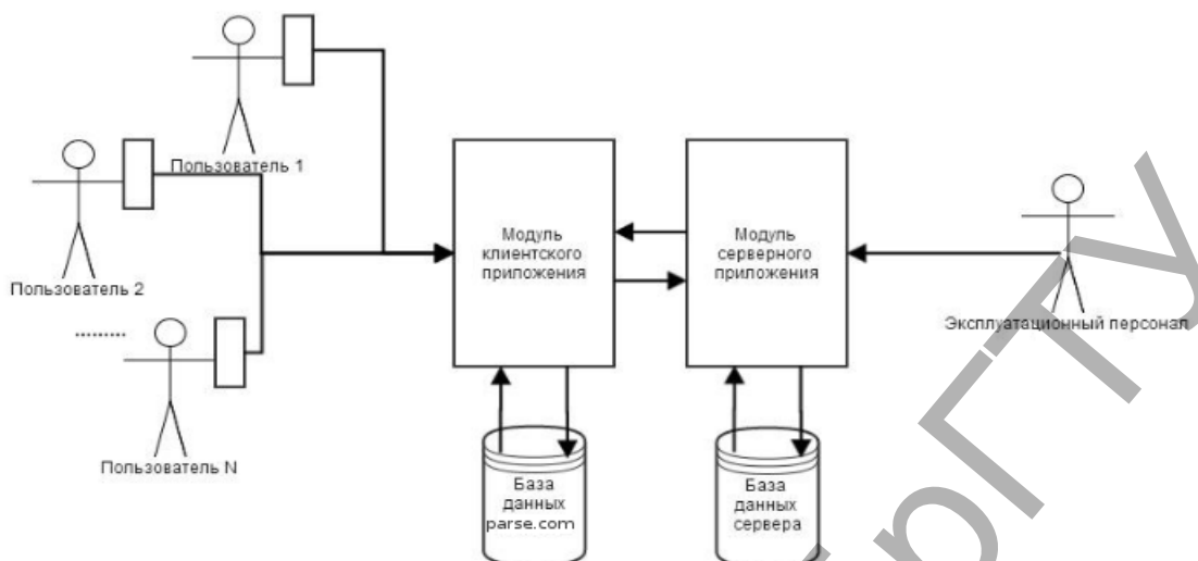
Рисунок 1 – Архитектура системы оценки параметров транспортных потоков
