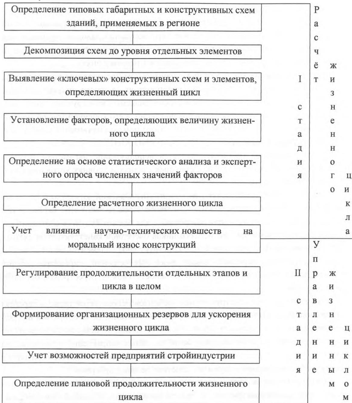
Рис. 1. Схема управления жизненным циклом сборных конструкций.
