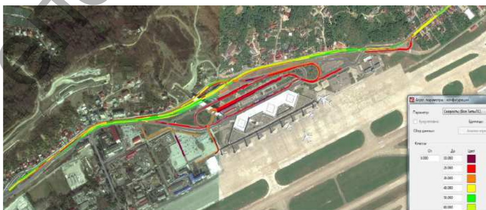
Рисунок 2 – Микромоделирование транспортных потоков в зоне аэровокзала г. Сочи
