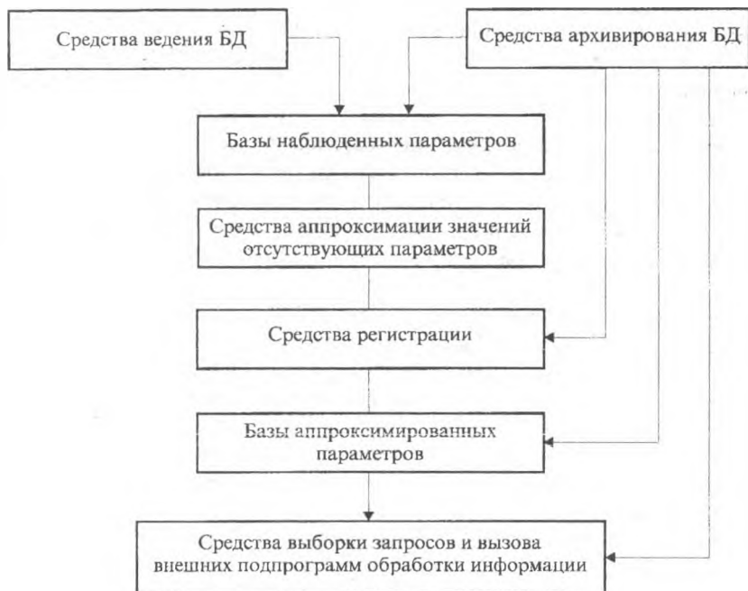
Рисунок 1 Принципиальная схема ИСС “Мониторинг и аудирование состояния окружающей среды (объекта - региона)”.
