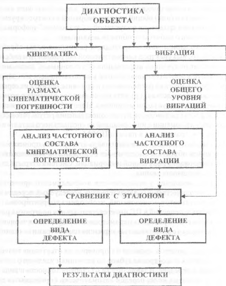
Рис. 1. Укрупненная блок-схема диагностики технического состояния зубчатых приводных механизмов ----- углубленная диагностика ————— упрощенная диагностика
