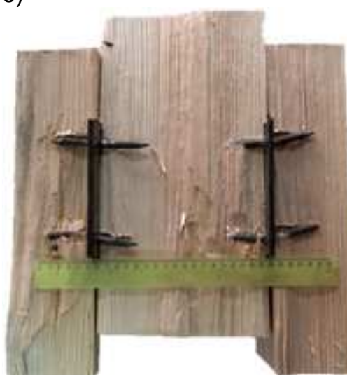
Рисунок 2 – Характер разрушения образцов
