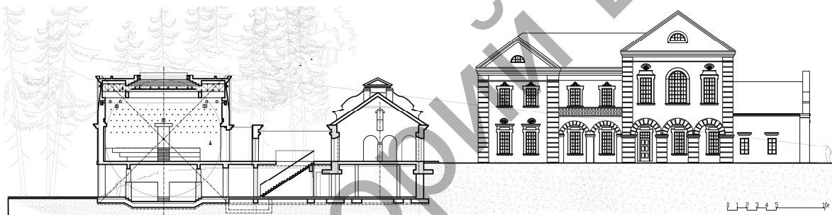
Фото 10 – Новая Греческая сцена с видом на усадебный фасад. Продольный разрез А-А
