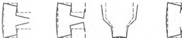
Рисунок 1 - Примеры потери устойчивости формы сечения
