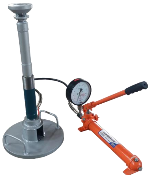
Рисунок 9.1 – Внешний вид пресс-штампа ПШ-050С
