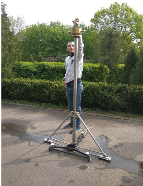
Рисунок 5.2 – Проведение испытаний по определению коэффициента сцепления прибором ППК
