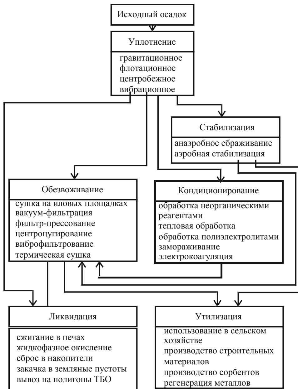
Рисунок 1 – Технологический цикл обработки осадков сточных вод
