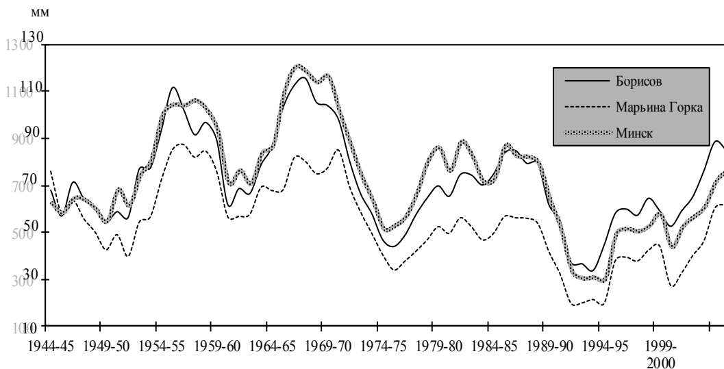
Рисунок 3 – Кривые скользящих 5-летних средних максимальных запасов воды в снеге для ряда метеопунктов Беларуси
