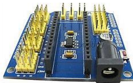
Рисунок 5 — Схема расширения к плате Arduino
