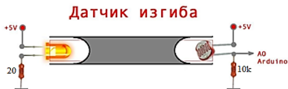
Рисунок 3 – Принцип работы датчика изгиба
