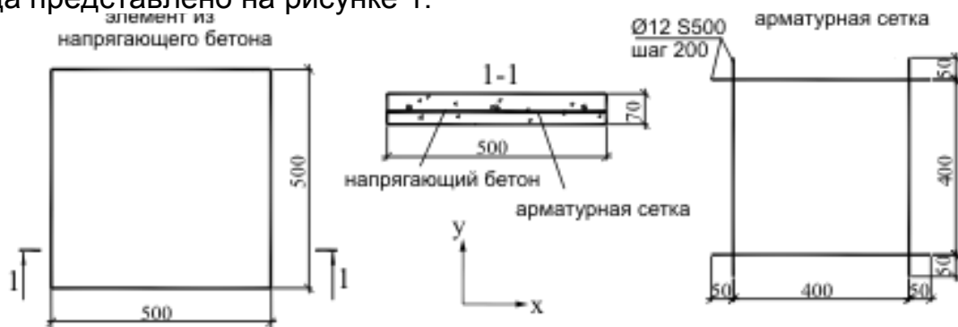
Рисунок 1 – Конструктивное решение плитного образца
