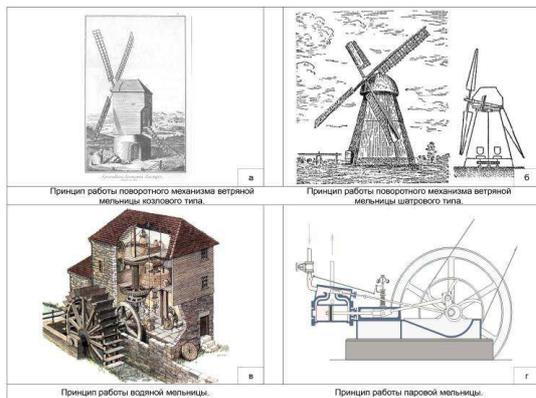
Рисунок 5. Принципиальная схема работы различных типов мельниц
